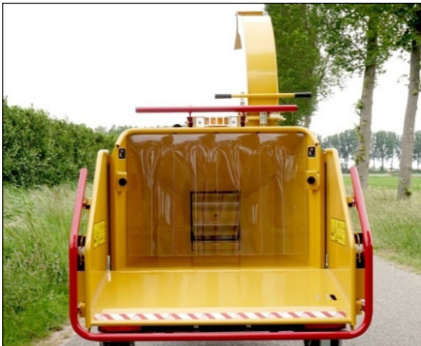
Figura 15. Ejemplo de elemento de protección (tiras de goma) en conducto de alimentación.
