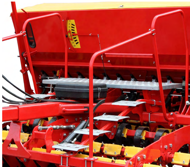
Figura 4b. Plataforma, escalera y pasamanos para acceso a la tolva.
