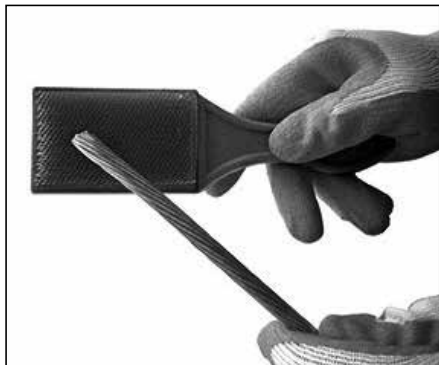
Figura 1. Limpieza de conductores.
