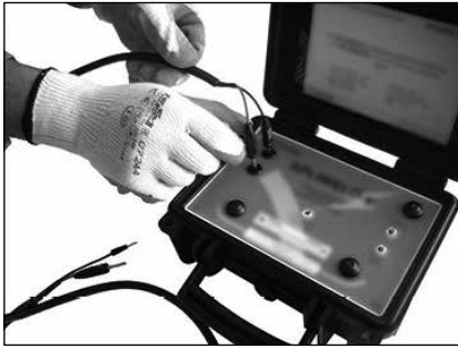
Figura 7. Conexión de los dos pares de bananas al equipo de encendido.
