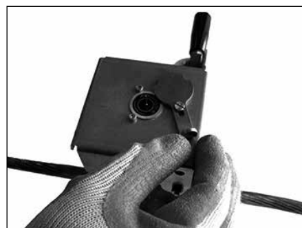
Figura 6. Colocación del iniciador electrónico inmovilizándolo con la palanca de seguridad.
