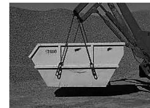
2. Este equipo se considera accesorio de elevación si no está unido o fijado permanentemente a la maquinaria de elevación, es decir, cuando la máquina se puede utilizar para elevar cargas sin el equipo o con otros accesorios de elevación.
