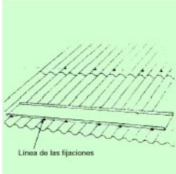
**Fig. 6: Pasarela instalada perpendicular a la pendiente**
