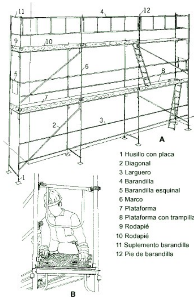
Figura 22. A: Coronación del andamio e instalación de elementos colectivos de seguridad. B: Instalación de rodapiés laterales
