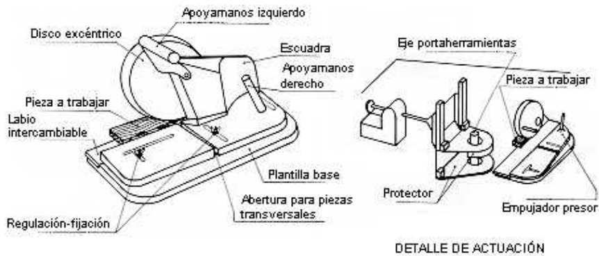
Fig. 23: Empujador de disco excéntrico
