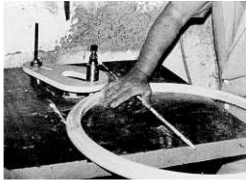
Fig. 29: Operación del árbol por el exterior de pieza (Fuente: A. Porlán - G.T.P. Murcia)
