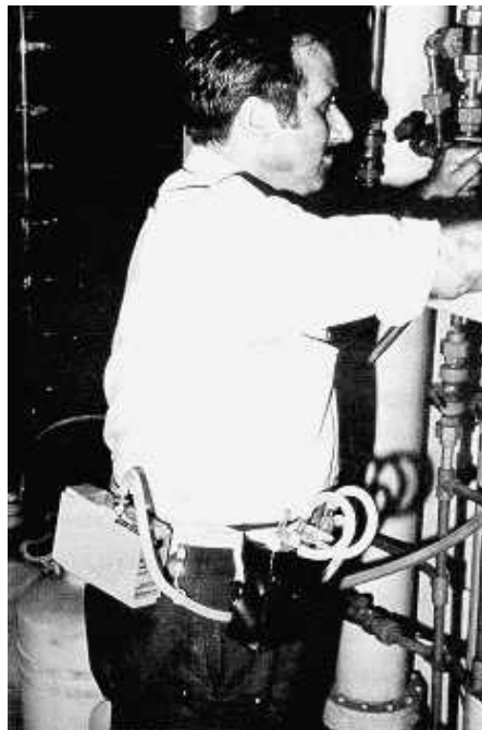
Fig .3: Toma de muestra con impinger
