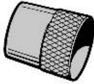
Fig. 4: Cuña anular para asegurar la unión de la cabeza con el mango
