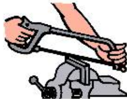
Fig. 13: Pieza fijada firmemente antes de serrar
