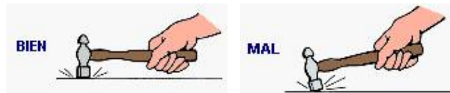
Fig. 7: Forma de golpear sobre una superficie
