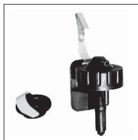
Figura 6. Ciclón de plástico SKC
