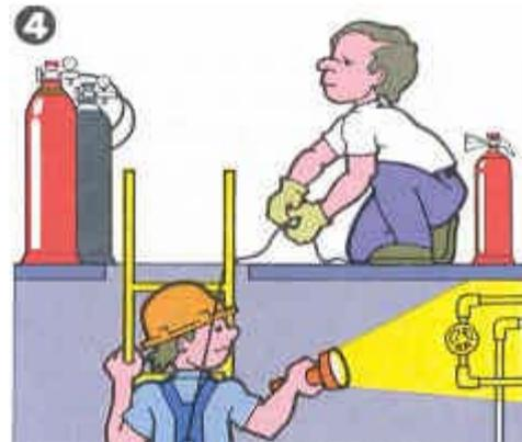
Entrada en las condiciones establecidas y con medios y equipos adecuados (ventilación suficiente, protecciones personales, escalera, cuerda de salvamento sujeta desde el exterior, etc.).
