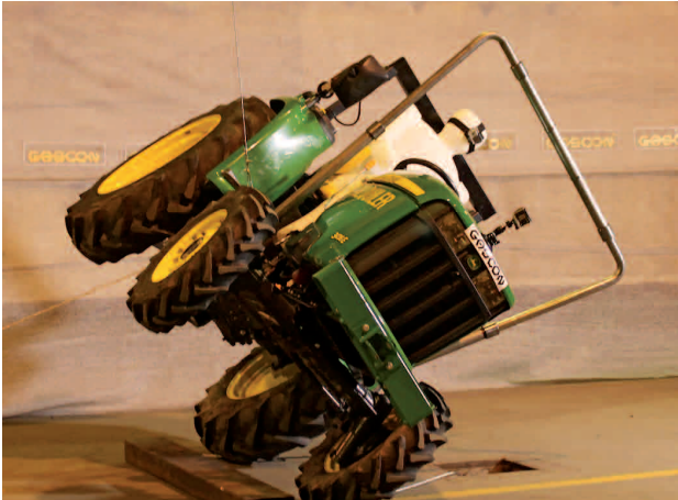
■ Figura 3 ■ Tipos de ROPS automáticas (AD-ROPS)
