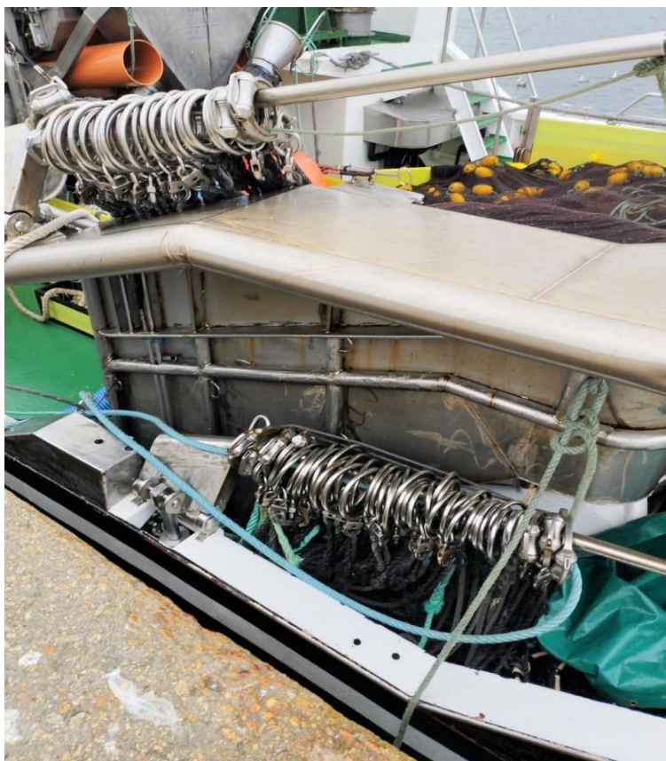
Figura 11: Barras (cañones) de estiba de las anillas de la jareta del aparejo del cerco.
