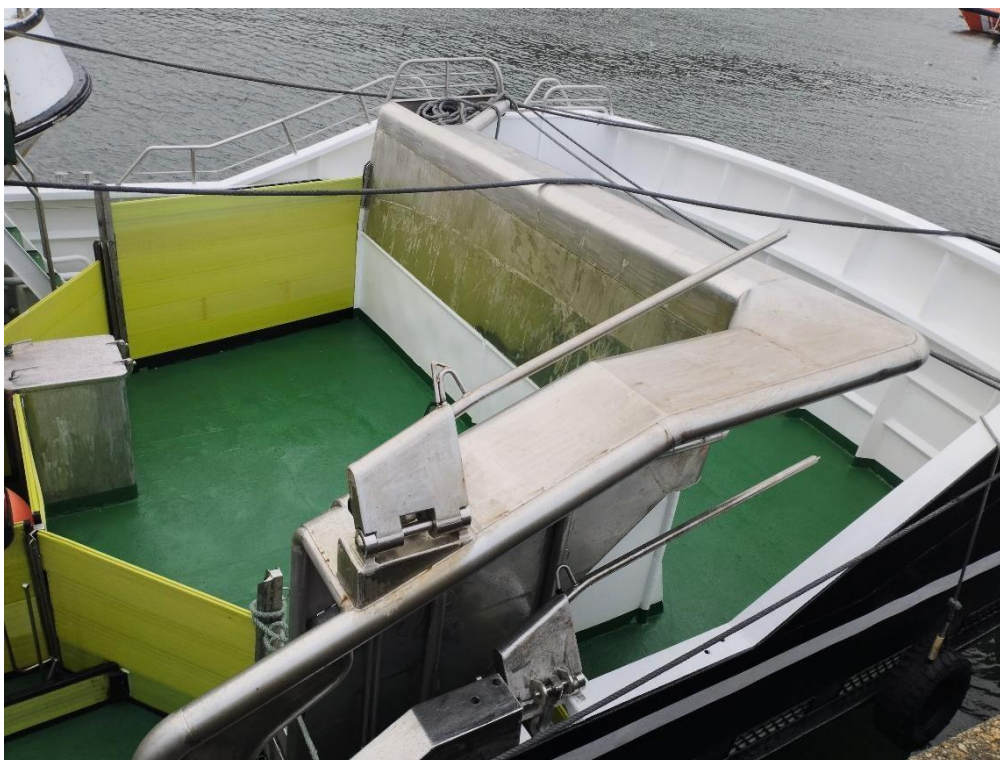
Figura 14_A: Espacios de estiba distintos (cajonadas) sin los aparejos.
