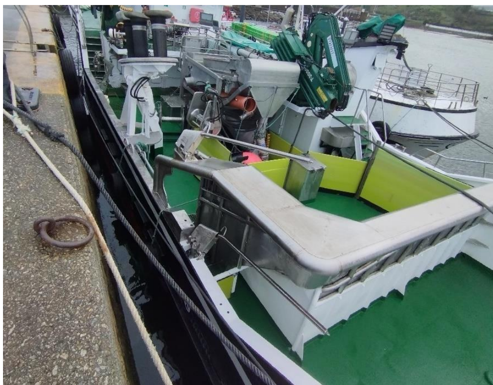
Figura 14_B: Espacios de estiba y sus protecciones para el Marinero
