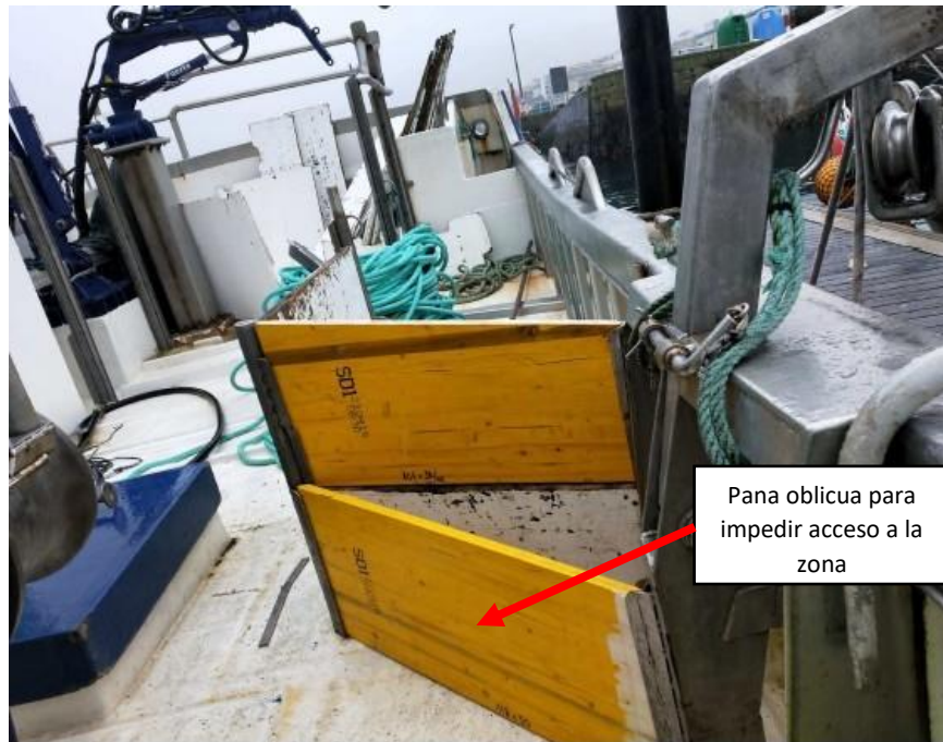
Figura 8: Colocación de panas suplementarias a proa de la cajonada
