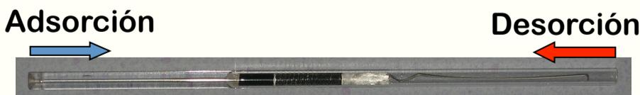
Invertir el flujo de desorción permite compatibilizar el tratamiento térmico de las diferentes secciones de carbón de los tubos y trampa
