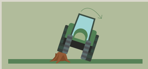
2. Irregularidad del terreno (hoyos, baches, piedras, tocones...)
