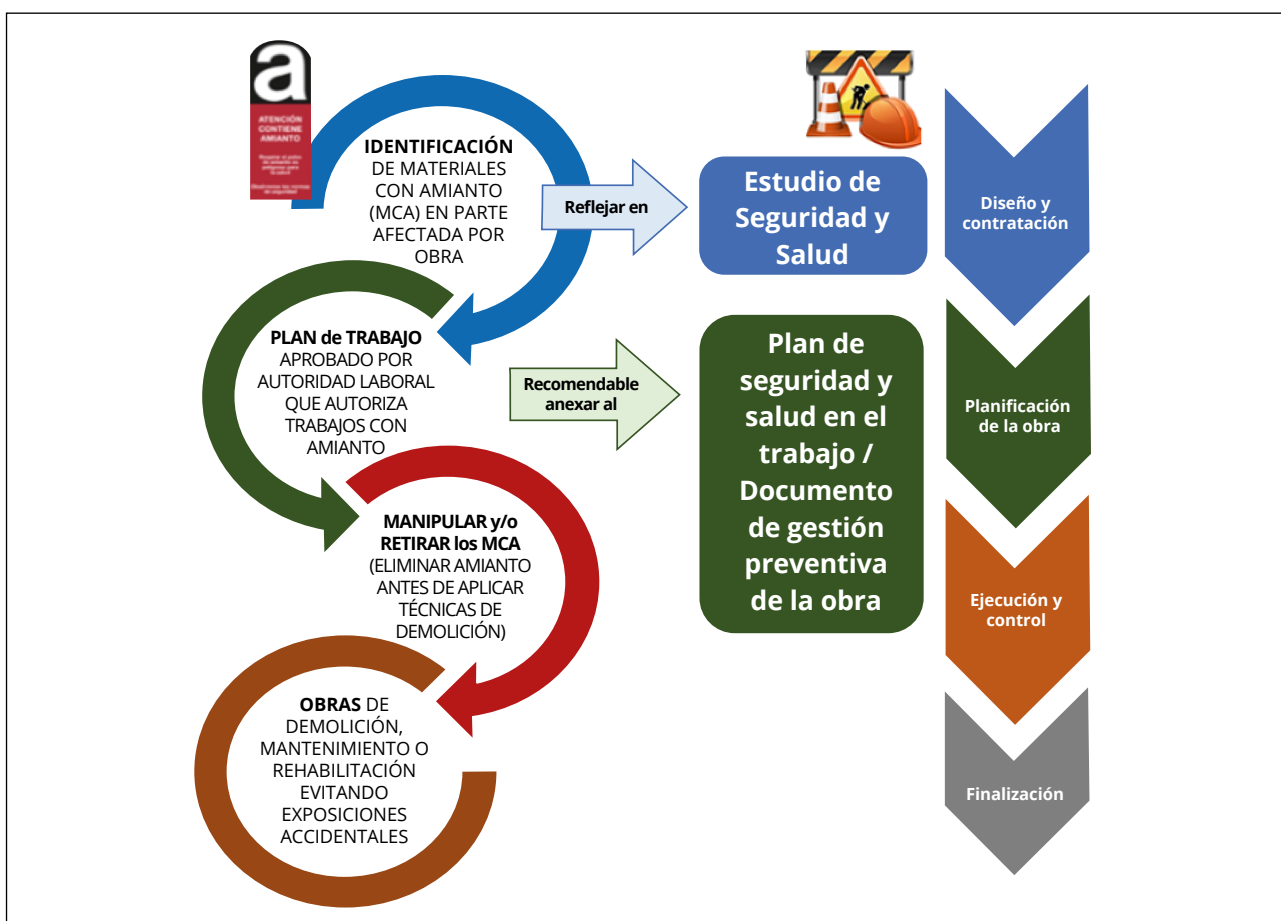
Figura 6 10 . Amianto en obras de demolición, rehabilitación, reparación o reforma.
