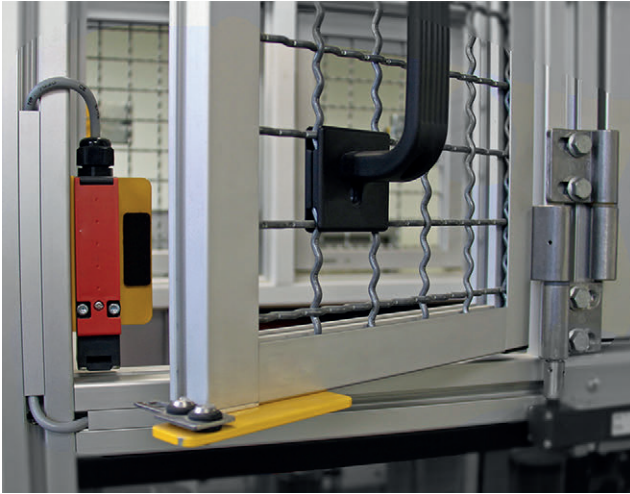
Figura 4. Resguardo móvil con dispositivo de enclavamiento tipo lengüeta. 74
