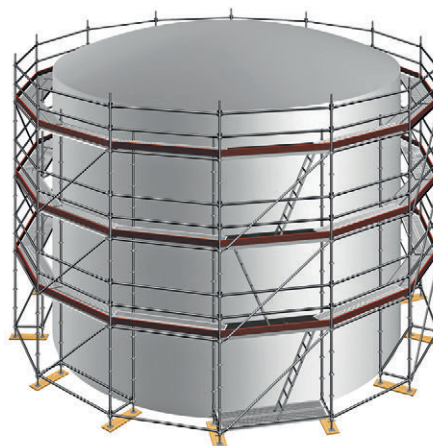
Figura 34. Ejemplo de andamio de fachada de componentes prefabricados.
