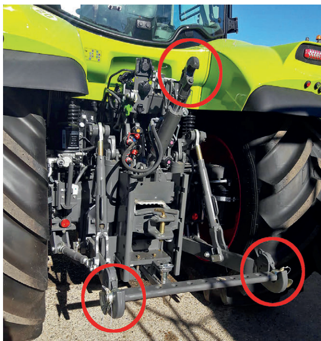
Figura 8. Sistema de enganche en tres puntos.
