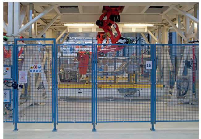
Figura 3. Resguardo fijo distanciador empleado como protección perimetral. 73
