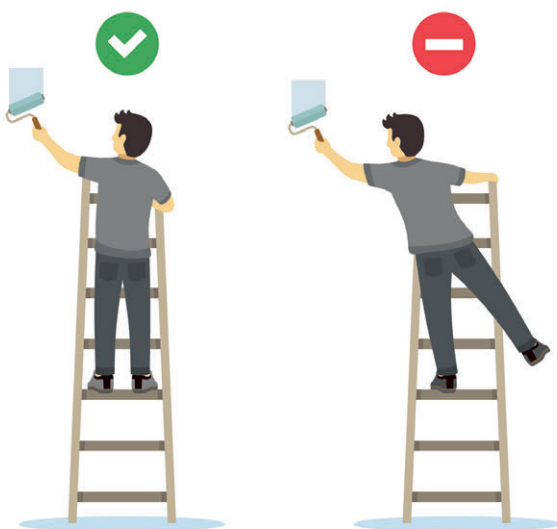
Figura 29. Posiciones de trabajo correcta e incorrecta en una escalera de mano.
