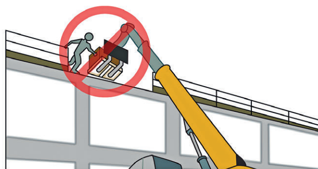
Figura 22. Interrupción temporal de la protección colectiva contra caídas sin medidas compensatorias y eficaces de seguridad.
