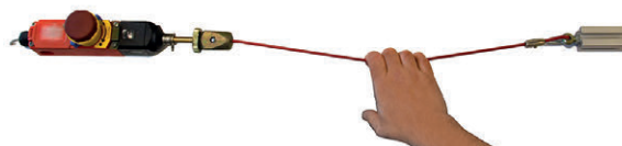
Figura 11. Cable de parada. 80
