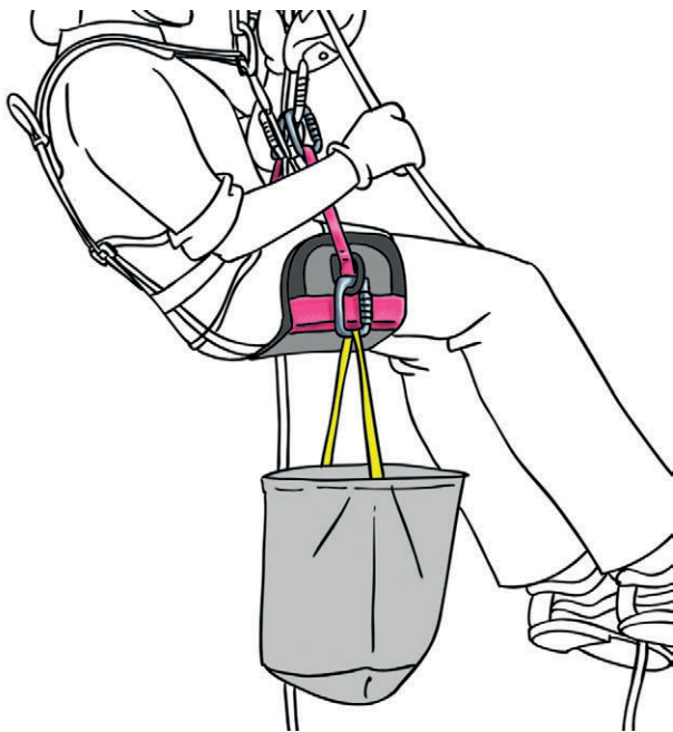
Figura 52. Ejemplo de herramientas u otros accesorios unidos al asiento.
