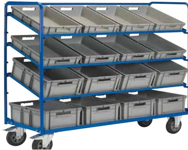
Fig. 3. Carro de paquetería con estantes cajones
