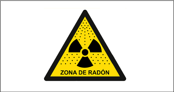
Figura 2. Modelo de señal para los recintos clasificados como zona de radón propuesto en el anexo A de la norma UNE 73001:2023.
