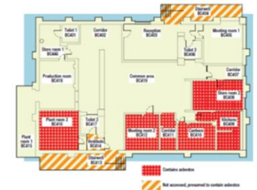
Ejemplo de un plano de localización de amianto en una instalación (Fuente HSE, 2012)
