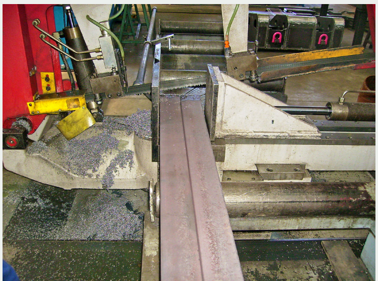
Figura 2: Imagen de pieza sujeta por mordaza
