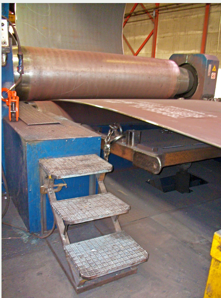
Figura 1: Curvadora de rodillos
