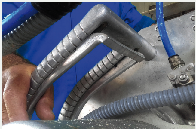
Figura 5. Modo de accionamiento simultaneo y mantenido de los órganos de accionamiento de la máquina (mando a dos manos)
