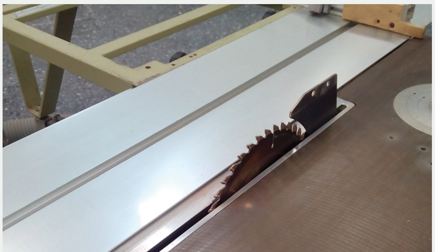
figura 5: nótese en la imagen que, para observar el cuchillo divisor colocado, se ha retirado el preceptivo resguardo autorregulable
