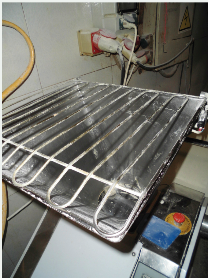
Máquina con resguardo móvil del tipo rejilla cerrado, asociado a un enclavamiento
