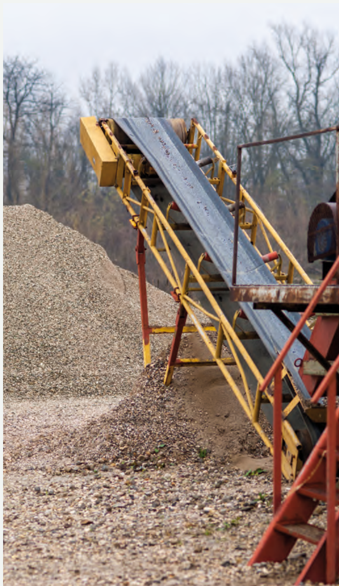
Cinta transportadora de materiales a granel
