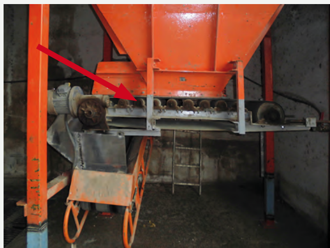
Detalle intersección entre banda/elementos fijos y rodillos
