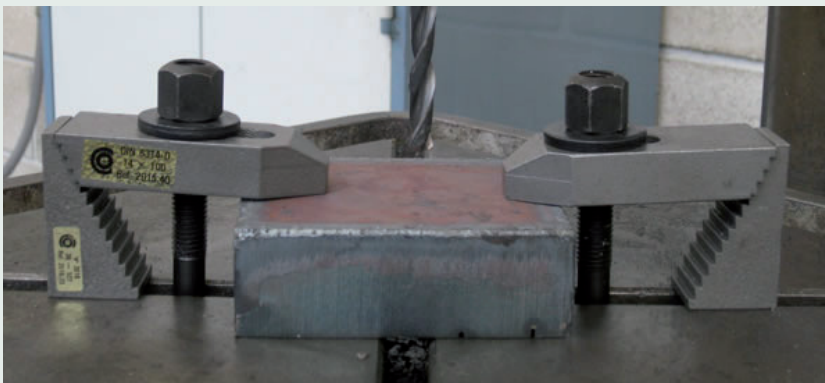
Pieza amarrada correctamente a la mesa mediante tornillos y bridas de sujeción
