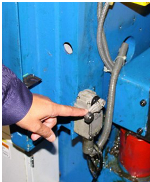
Figura 3: Posibilidad de burlado del enclavamiento debido a una instalación incorrecta (acción mecánica NO directa)
