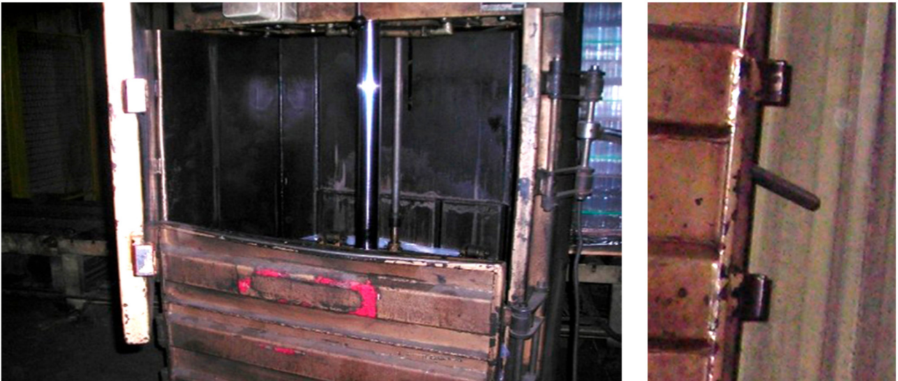
Figura 2: Sujeciones y bisagras en mal estado
