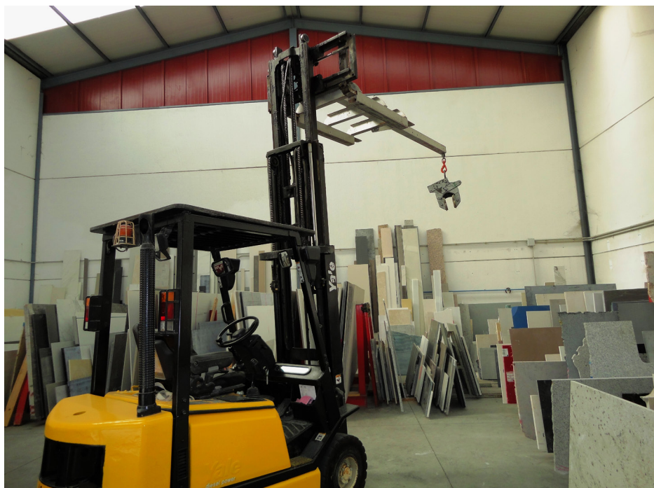
Figura 2: Carretilla elevadora automotora equipada con un accesorio para el transporte de cargas no guiadas
