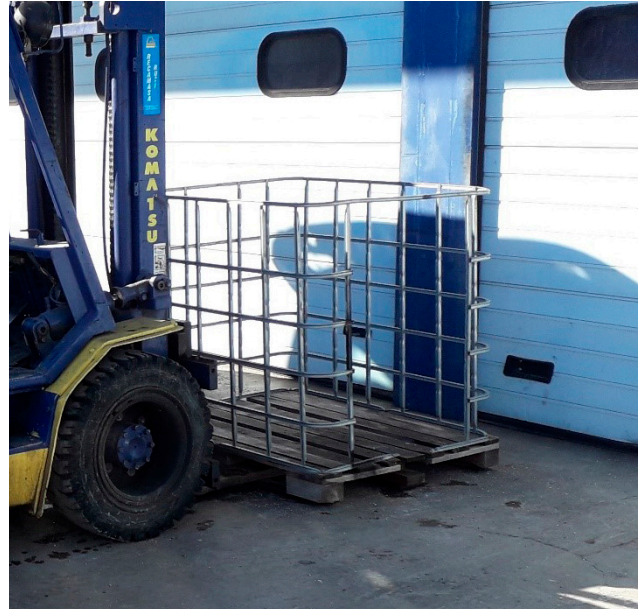
Figura 3: Jaula o barquilla acoplada a la carretilla
