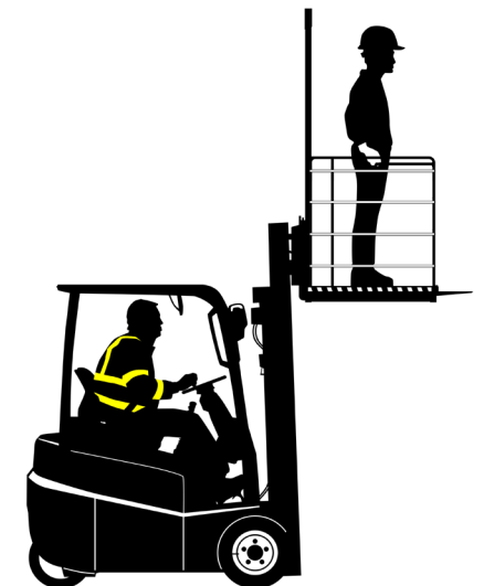
Figura 4: Elevación de persona mediante accesorio acoplado a la carretilla
