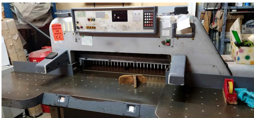
Figura 3: Guillotina con dispositivo electrosensible complementado con un mando a dos manos
