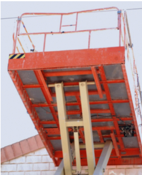
Figura 2: Contacto de la barandilla de la PEMP con partes en tensión
