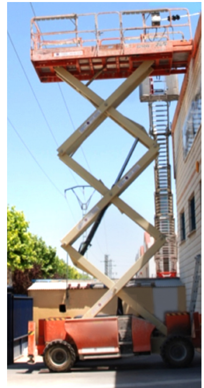
Figura 3: PEMP trabajando en un entorno con presencia de líneas eléctricas
