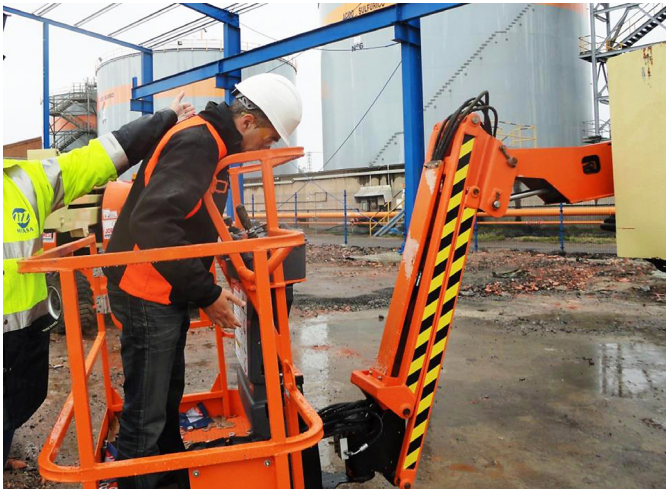
Figura 2: PEMP con dispositivo antiatrapamiento de tipo sensible
