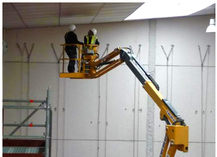
Figura 3: PEMP trabajando en altura con presencia de obstáculos por encima de la plataforma
