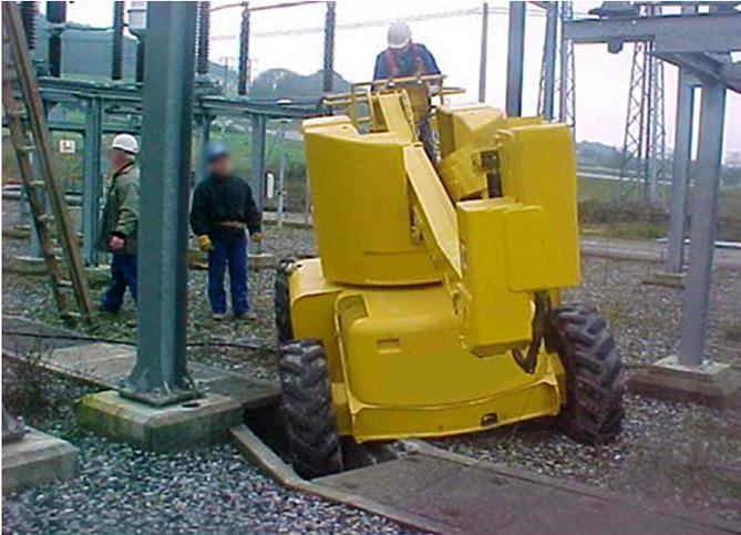
Figura 2: Incidente de una PEMP debido a una mala planificación del trabajo
