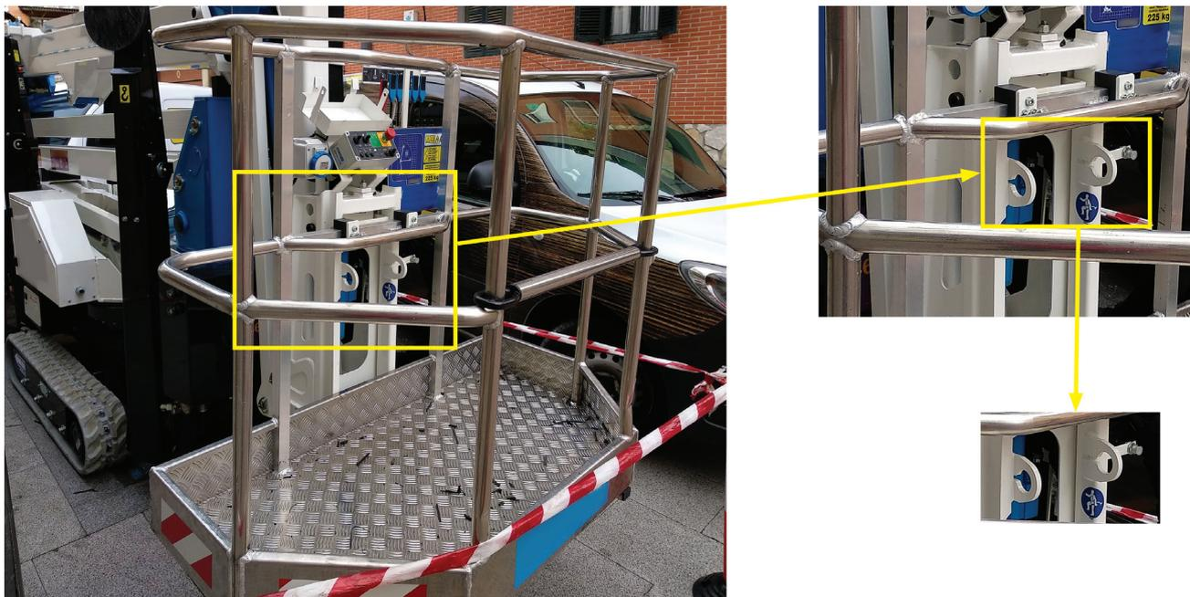
Figura 4: Puntos de anclaje en PEMP
