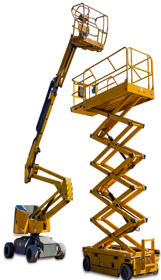
Figura 1: Plataformas elevadoras móviles de personal
