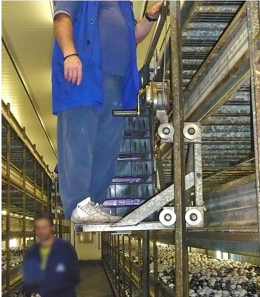
Figura 2: Elevación de la plataforma con un "único" cable
