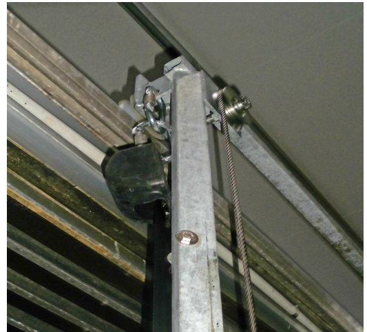
Figura 3: Detalle del bastidor y guía/carril
