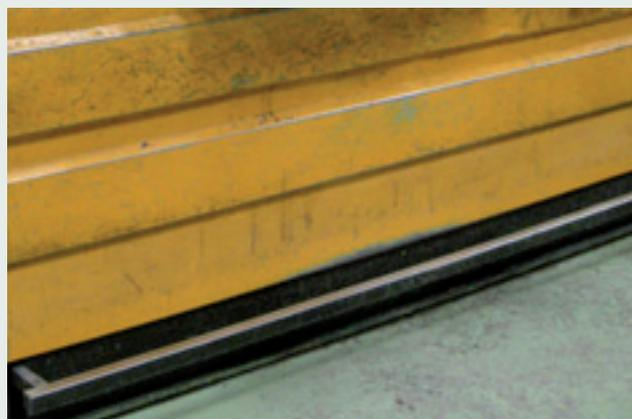
Detalle de barra de mando de una prensa plegadora hidráulica
