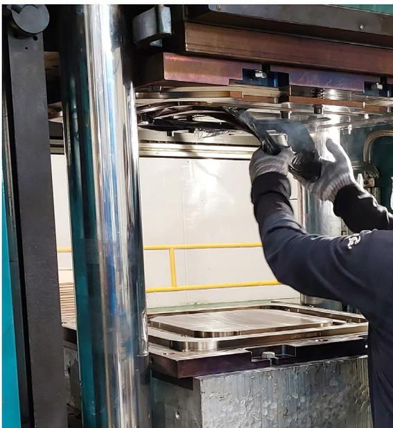
Figura 1: Extracción de las piezas vulcanizadas
