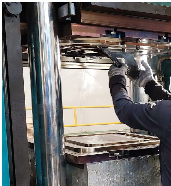
Figura 1: Extracción de las piezas vulcanizadas
