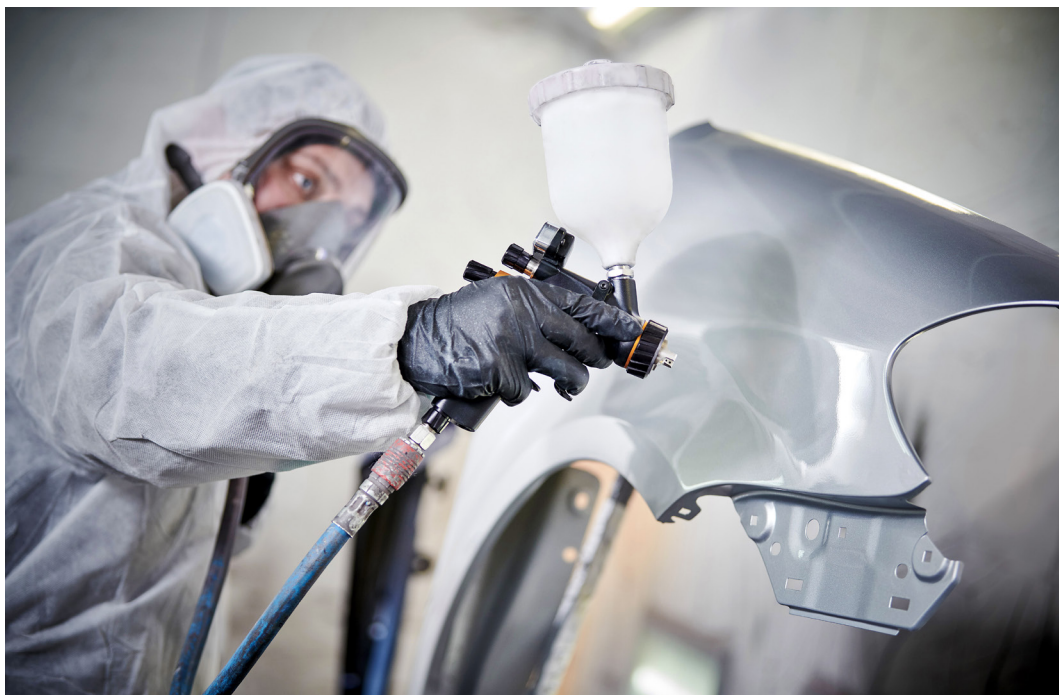
Figura 1: Pulverización de pintura en cabina
