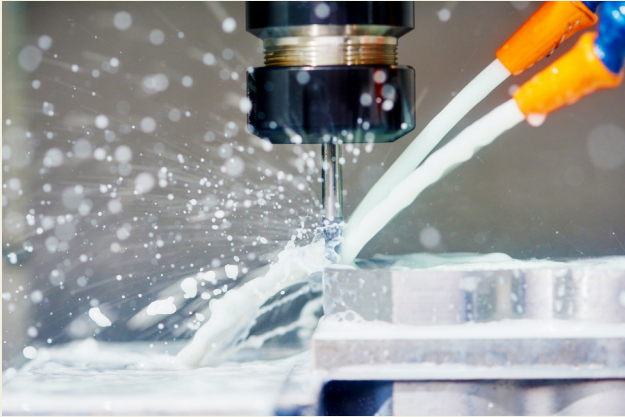
Figura 3: Fluido de corte sobre broca
