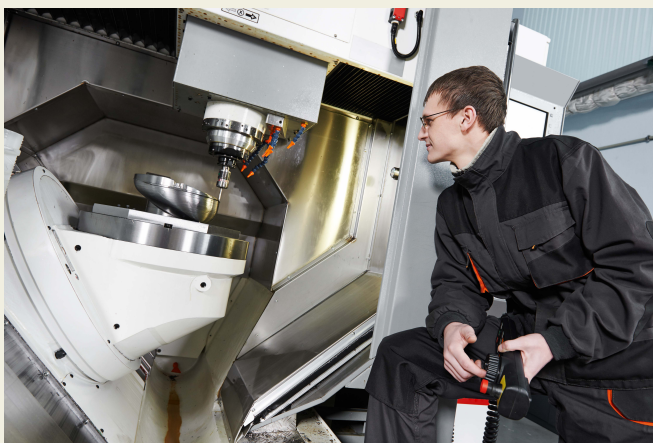
Figura 4: Centro de mecanizado
