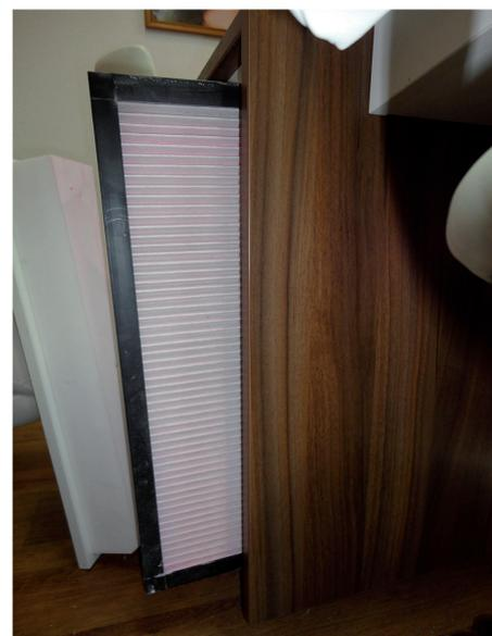
Figura 3: Mesa dotada de filtro para partículas y vapores y detalle de filtro
