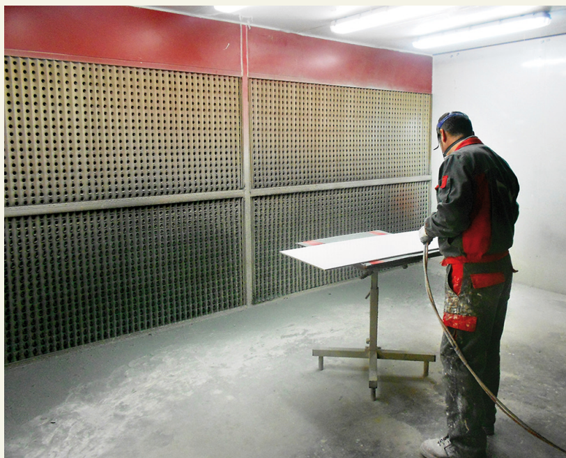
Barnizado en cabina de pintura
