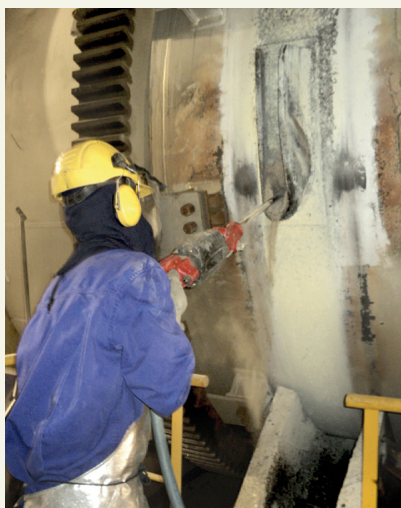
1. Apertura de piquera con martillo neumático - 2. Apertura de piquera con útil - 3. Caída de colada
