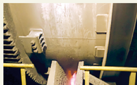
1. Apertura de piquera con martillo neumático - 2. Apertura de piquera con útil - 3. Caída de colada
