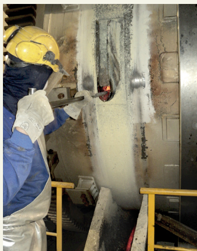
1. Apertura de piquera con martillo neumático - 2. Apertura de piquera con útil - 3. Caída de colada
