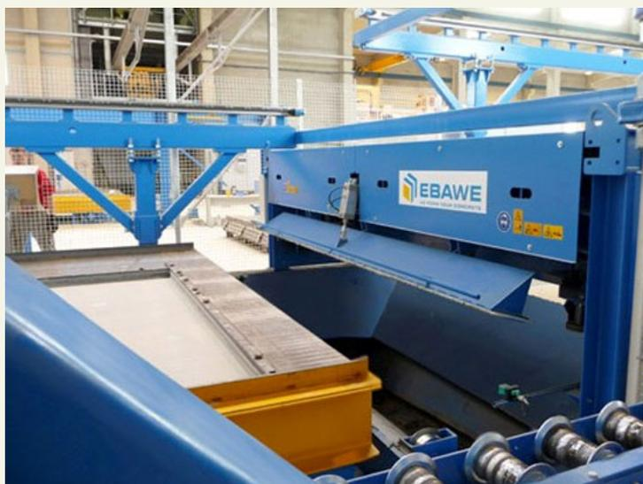
*Instalación para limpieza de bandejas y aplicación de desencofrante.
