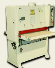
Dentro de este tipo se distinguen las **lijadoras de banda oscilantes**, que presentan numerosas ventajas, ya que la oscilación permite un acabado sin rayas y reduce el calentamiento de la banda de lija. Se emplea una **banda de lija** de unos 150 mm x 2200 mm, pudiendo trabajar en posición horizontal y vertical, o en cualquier ángulo entre ambas.
