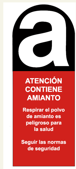
Etiqueta reglamentaria para materiales con amianto
